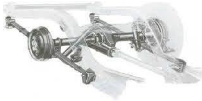
Figura 13 - Suspensão traseira Hotchkiss (Fonte: GILLESPIE, 1992, p. 239)
